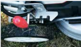
Stellen Sie ganz bequem per Handgriff die gewünschte Schnitthöhe ein – zentral in 7 Stufen zwischen 25–80 mm.
