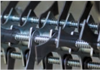
Messeranordnung Die pendelnd eingebauten Messer zentrieren sich durch die Fliehkraft (370 N) selbst und weichen bei Widerstand aus.
