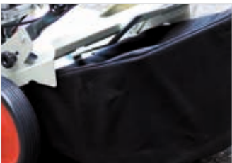
Fangkorb Zum Arbeiten mit Fangkorb einfach die selbst-schließende Klappe (Schutz gegen Stein-schlag) anheben und den Korb einhängen.
