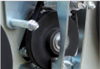
Keilriemenantrieb Ein gezahnter Keilriemen treibt die Messerwelle an. Die Kupplungsrolle ist kugellagert.
